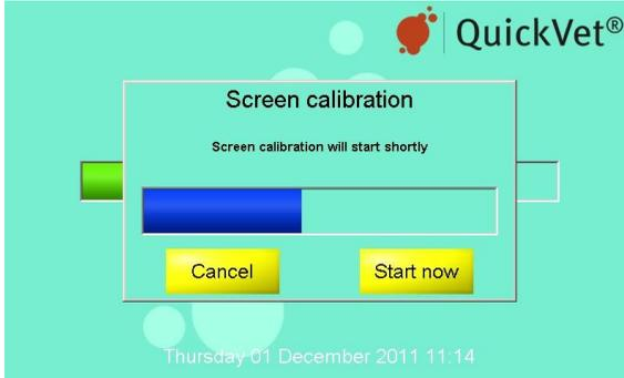
**Figura 6.1:** Pantalla Calibración. A la calibración de la pantalla puede ser iniciado por tocar la pantalla táctil del QuickVet® analizador durante el arranque.
