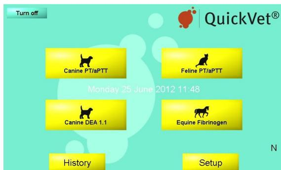
**Figura 3.1:** Pantalla de Inicio. La pantalla principal contiene botones para iniciar un nuevo análisis, revisar el historial de resultados, y modificar la configuración de instrumentos, así como apagar el instrumento.
