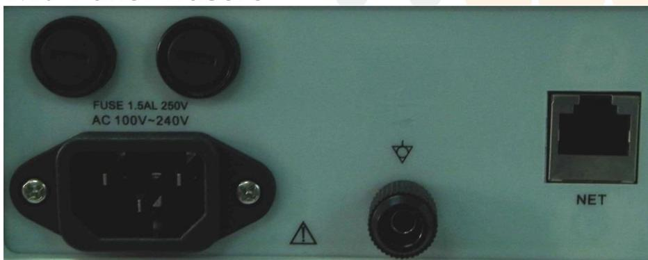
En el panel trasero como tabla 1.15, hay dos fusibles, receptáculo de energía del monitor, poste de tierra y equipotencialidad RJ45 red de toma de.
