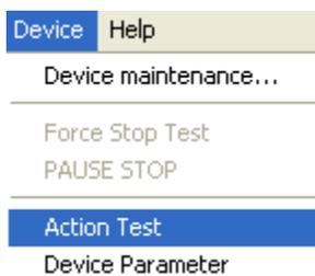
En este menú el ingeniero podrá checar cada uno de los movimientos de las partes mecánicas, velocidad de motor y condiciones de trabajo de las válvulas.
