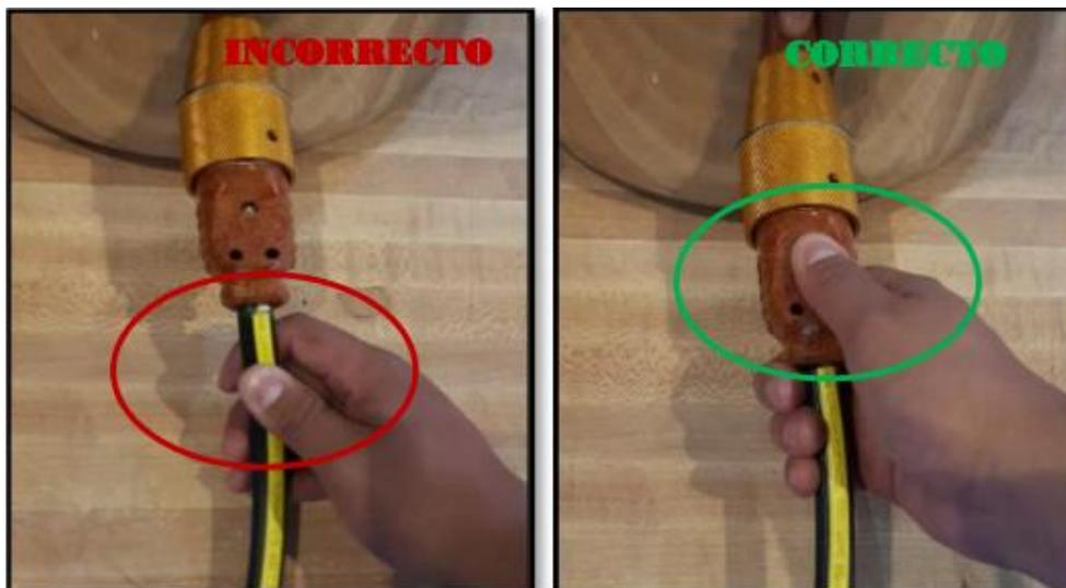
No doblar el cable por ningún motivo, ya que puede generar que queden expuestos los componentes y esto puede provocar un daño.
