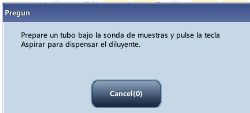
2. Presente un tubo limpio en la sonda de muestras y presione la tecla de aspiración para dispensar diluyentes (480 µl). La barra de progreso de suministro aparecerá en la pantalla.
