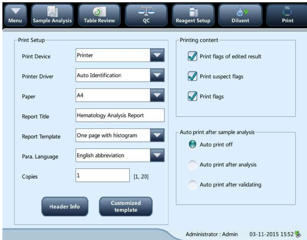
λ Configuración de impresión Dispositivo de impresión Puede seleccionar "Impresora" o "Grabadora" en la lista desplegable "Dispositivo de impresión". Unidad de impresión Toque la lista desplegable para seleccionar la unidad de impresión del analizador. Papel Toque la lista desplegable para seleccionar el tipo de papel de los informes que se imprimirán
