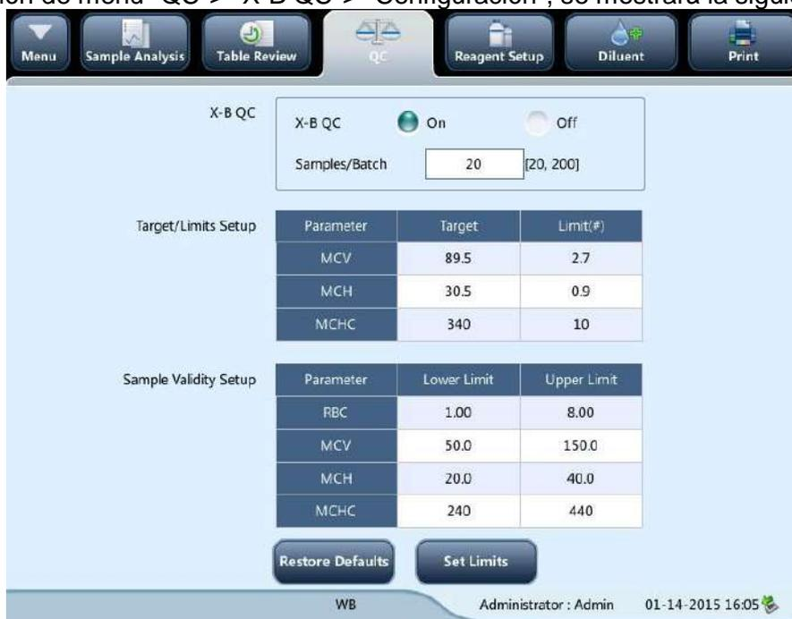
En la pantalla de configuración X-B QC, puede activar / desactivar X-B QC, establecer objetivos / límites y configurar la configuración de validez de la muestra.
