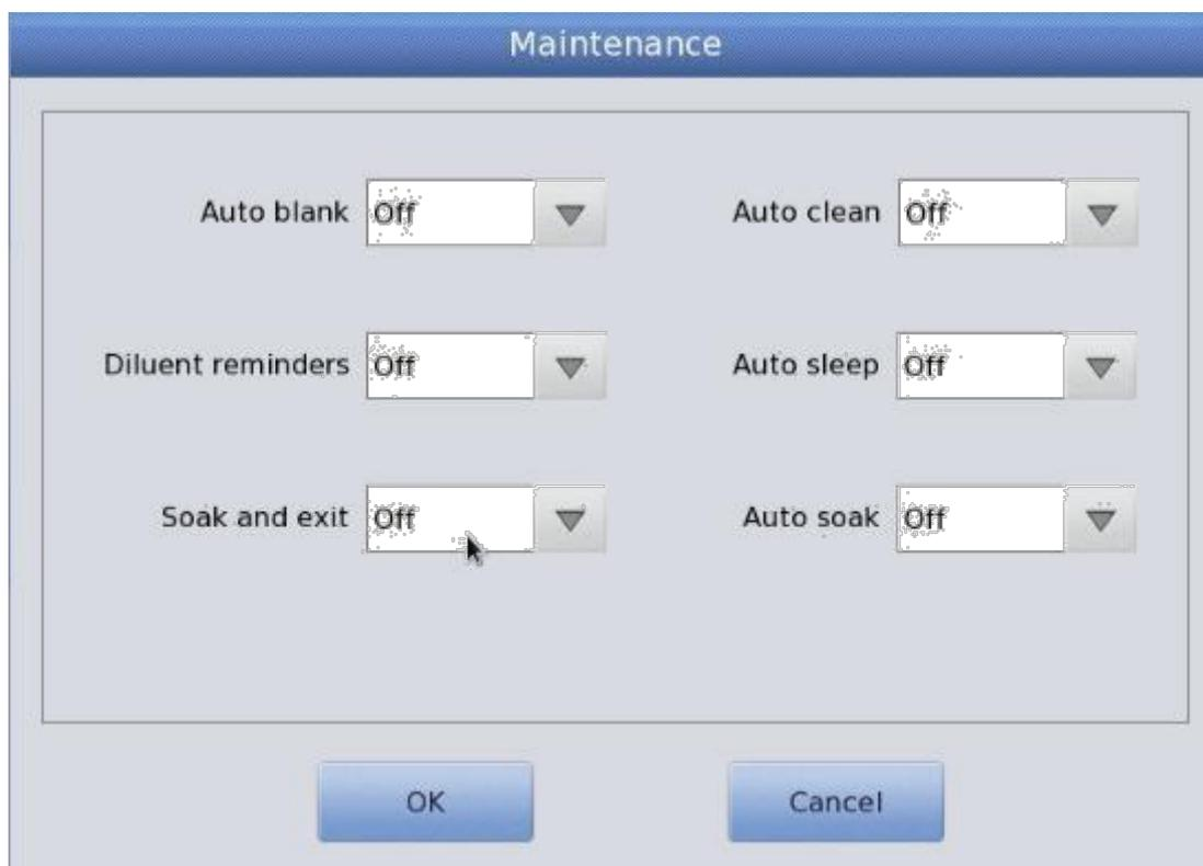
Para obtener resultados correctos, es necesario limpiar las cámaras de recuento y enjuagar el sistema de flujo para evitar errores de medición causados por residuos. El programa de apagado debe realizarse cuando el analizador analiza más de 500 muestras o finaliza el trabajo de hoy. Si usa continuamente el instrumento, el programa de apagado debe realizarse una vez al menos cada 24 horas. Para obtener instrucciones detalladas, consulte el capítulo 7, Operación diaria.
