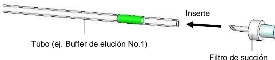
5. Luego de que los tres filtros han sido reemplazados, ejecute PRIME (cebado) para el Buffer de Elución No. 1, 2, y 3 en la pantalla REAGENT CHANGE (cambio de reactivo).
