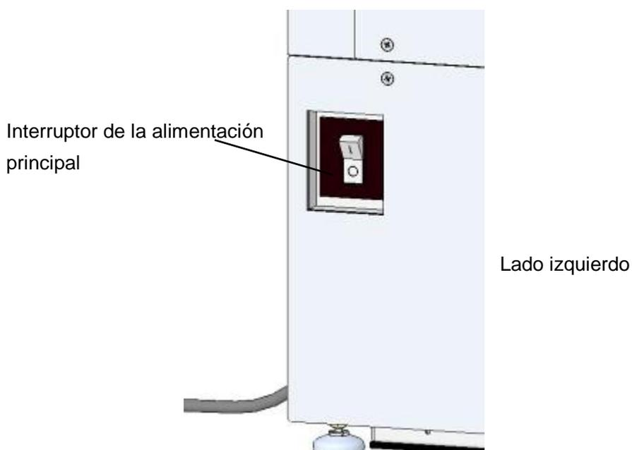
El interruptor de alimentación principal también actúa como un disyuntor. Si el interruptor de alimentación principal se apaga inmediatamente después de encenderlo, el analizador puede estar en cortocircuito. Si esto ocurre, tenga cuidado de no tocar ninguna parte metálica del analizador. Apague inmediatamente la alimentación principal, desenchufe el cable de alimentación del tomacorriente y póngase en contacto con los representantes locales de Tosoh.
