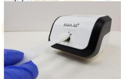
Fig. 6 Secar la cámara de pruebas con una esponja
