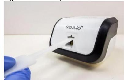
Fig. 5 Inserte la paleta de limpieza boca abajo y boca arriba
