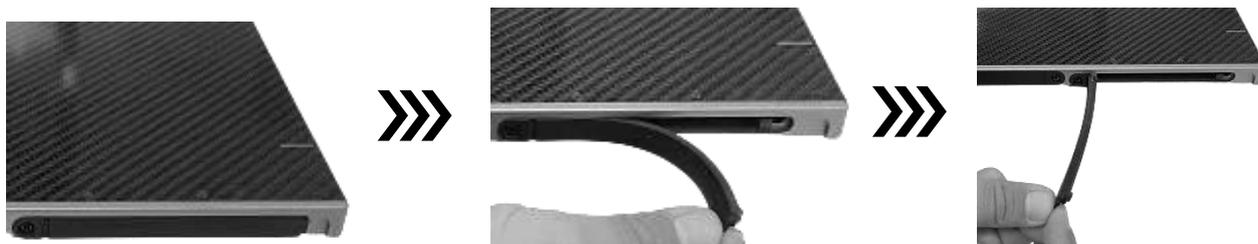
Paso 2. Inserte la batería hasta que se atasque en la base de bloqueo.
