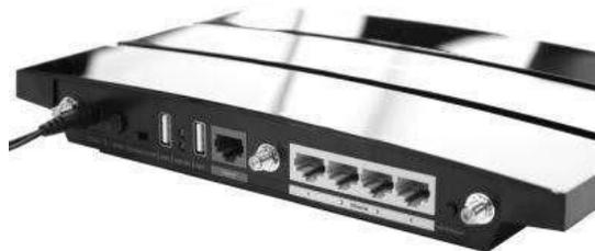
3) Encienda el interruptor de encendido/apagado inalámbrico y presione el botón de encendido.
