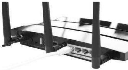
1) Conecte el cable LAN al puerto ethernet (no internet) del AP y el otro al conector de la tarjeta LAN de la estación de trabajo asignada para la transferencia de datos.
