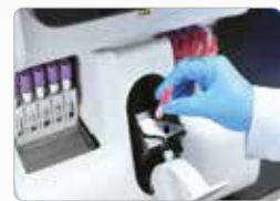
STAT perforador de tapa Admite muestras STAT y muestras de sangre capilar; minimiza los peligros de bioseguridad
