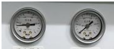
Presión de entrada arriba; Alta presión debajo
