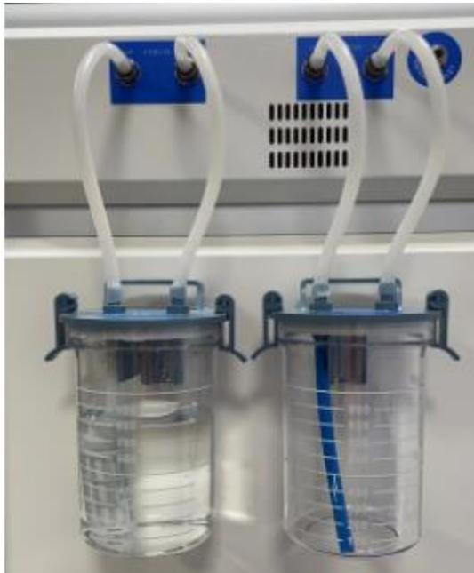
4. Ponga medio paquete de polvo desinfectante UCI en el bote. El polvo se vuelve rosa al contacto con el agua y suele llenarse con 600 a 800 ml de agua. Además, hay un racor largo dentro del bote para insertar el tubo de conexión de silicona a lo largo del exterior de la tapa hasta el conector rápido izquierdo. Tenga cuidado de no insertarlo al revés. De lo contrario, el líquido del interior del depósito será bombeado a la cámara.
