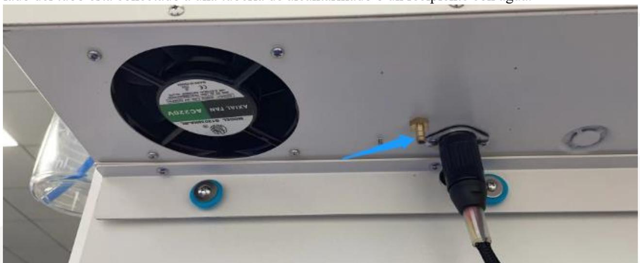
2. Instale el bote de cal sódica. La cantidad de cal sódica instalada en el recipiente escala de 800ml a 1000ml. Preste atención al interior del bote por un tubo largo. La conexión rápida de silicona se inserta en el puerto de acceso directo en el lado de la vida, a continuación, inserta uno por uno para completar la instalación del tanque de adsorción de dióxido de carbono.
