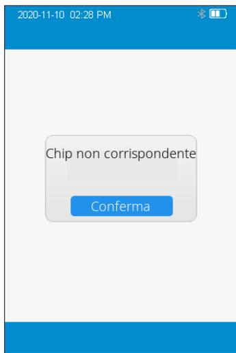
Cuando el número de Codechip de entrada del líquido QC no coincide con la información del Codechip, el sistema proporcionará un mensaje de advertencia indicando que la información del Codechip no coincide.
