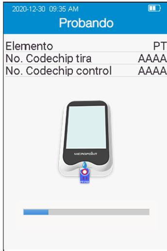
Después de agregar el líquido QC, el sistema iniciará automáticamente la prueba de QC y mostrará el progreso de la prueba (Figura 4-8).
