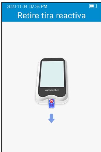
Si la tira reactiva no se ha extraído después de completar la prueba de QC, haga clic en "🏠" en la pantalla de resultados de la prueba para ir a la pantalla de extracción de la tira (Figura 4-10) y retire la tira reactiva en la dirección que se muestra en la figura. Si después de completar la prueba de QC la tira reactiva se retira de la pantalla de resultados, la pantalla saltará directamente a la pantalla principal.
