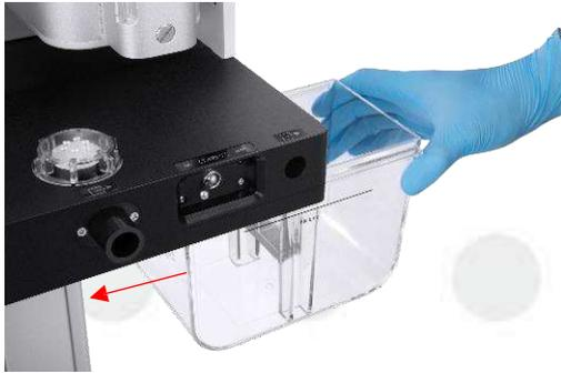
Coloque la caja absorbente en el cuerpo principal del circuito a lo largo del soporte.
