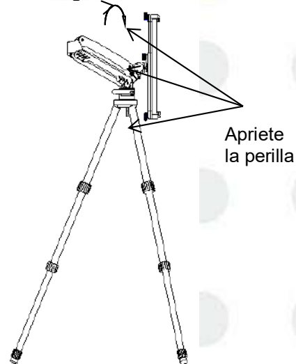
Figura 3-27 Ángulo de colocación del detector digital
