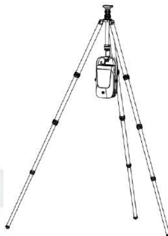
Figura 3-13 Arreglar la unidad de rayos X
