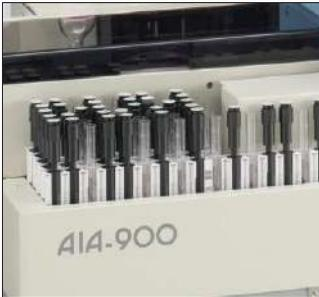
Tazas y tubos de carga para el modelo de cargador
